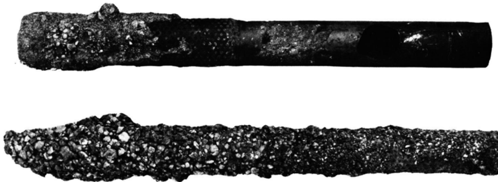
Figura N° 1 Ejemplo de rejilla obstruida
